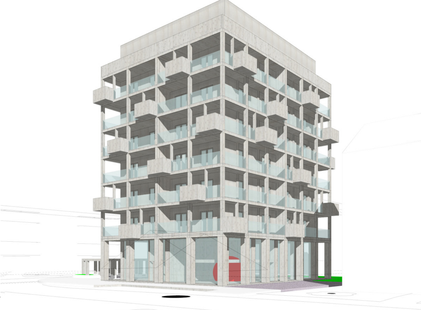
Studie av fasade med kasser for busker og trær hengt utenpå balkongene. Kassene veksler posisjon slik at alle får regnvann
