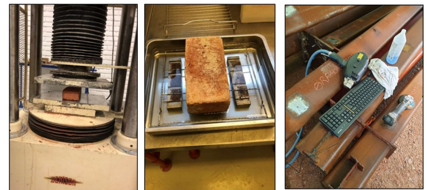
Testing hos Sintef i Oslo; hhv. trykkprøving og minuttsg. Foto: Sintef
