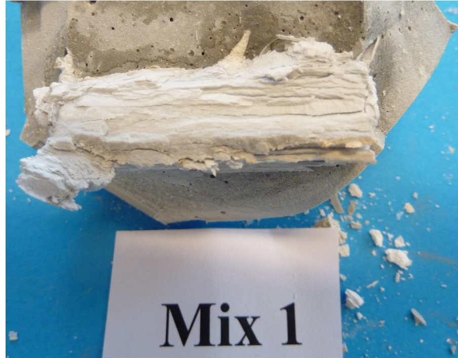
Rester av aluminiumstang etter 8 måneder i sementpasta
